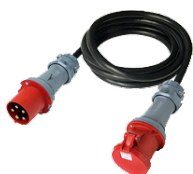
5G16mm² CONEXIÓN CETAC CEE 63A-5P Potencia Máxima 40KVA; Long.: 10, 20, 50 y 100 metros.
