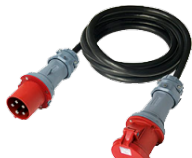
5G10mm² CONEXIÓN CETAC CEE 63A-5P Potencia Máxima 40KVA; Long.: 10, 20, 50 y 100 metros.
